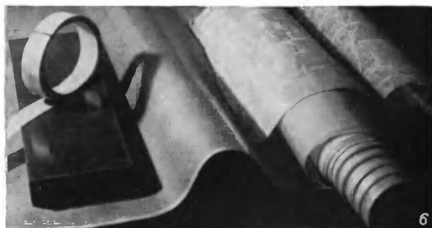
Стекловолоконное и изделия из него: 1 — крученая нить; 2 — штапельная пряжа; 3 — электроизоляционный шнур и лента; 4 — провода с изоляцией из стеклянного волокна; 5 — стеклянная ткань; 6 — материалы, полученные на основе стеклянных тканей (стеклотекстолит, стекломиканит, прорезиненная стеклоткань)
